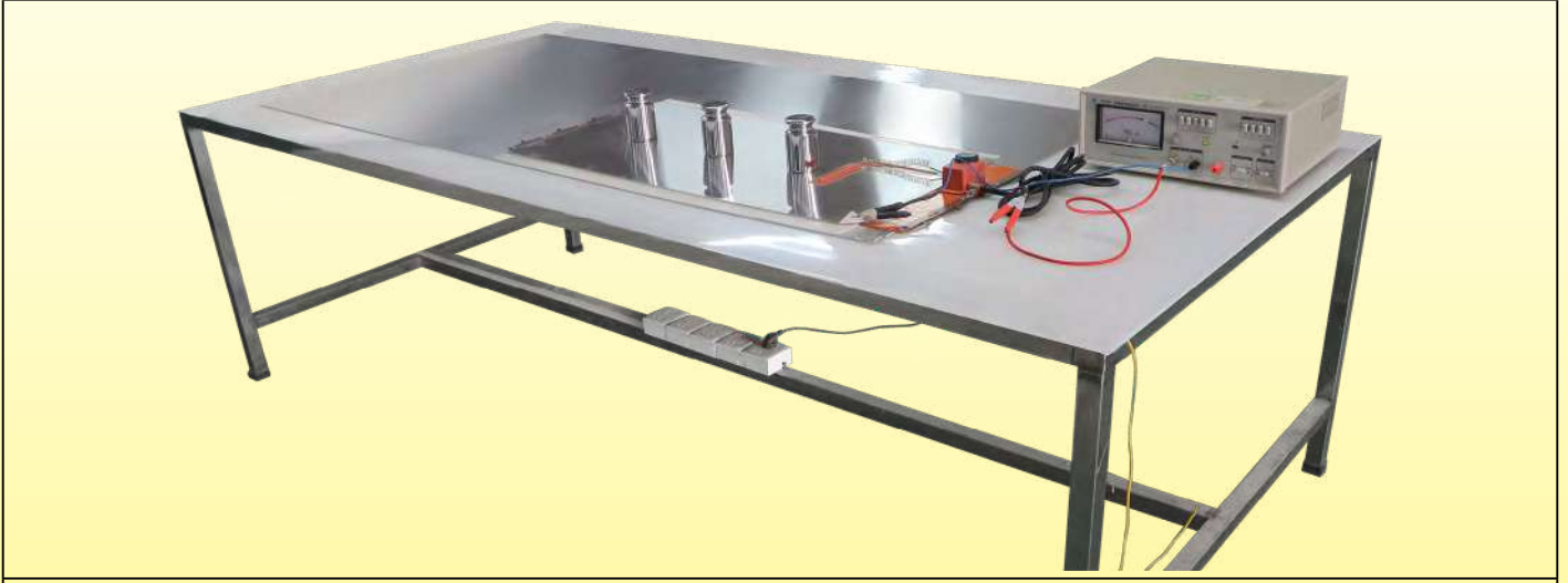
用于测量绝缘电阻的设备 测量的数值通常大于 0.1Gohm
