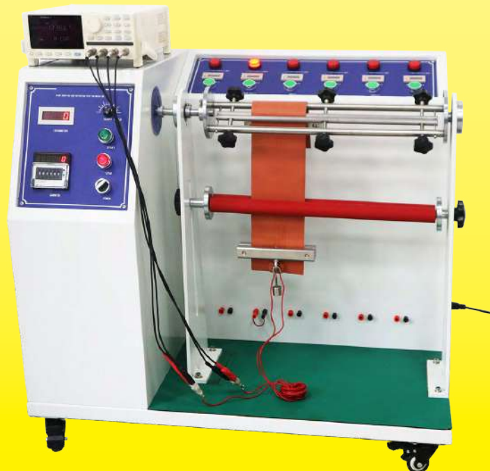
弯曲试验中的柔性硅胶加热器
