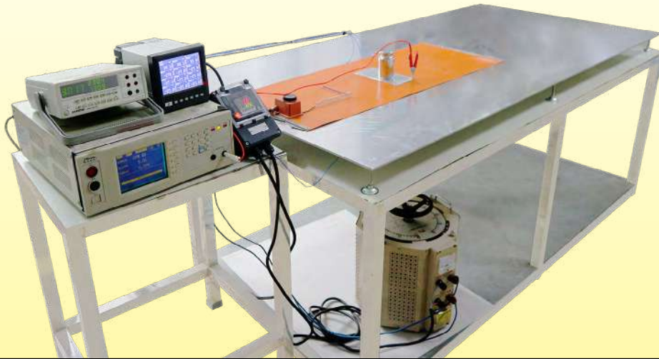
在热态的条件下总泄漏电流的测量设备
